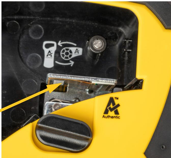
5. Brossez doucement le cylindre avec un coton-tige propre. Il se peut que vous deviez déplacer le levier de verrouillage en position verrouillée pour accéder au cylindre.
