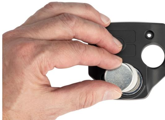
2. Positionnez l'aimant à l'arrière de l'imprimante de manière à ce que les trous de vis soient alignés.
