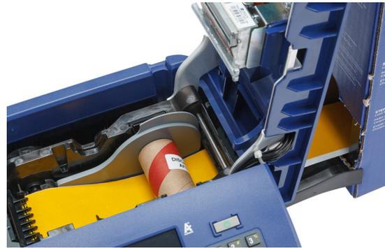
7. Continuez à faire passer le bord avant du rouleau d'étiquettes sous le mandrin. Insérez l'extrémité libre de l'étiquette jusqu'à la ligne noire sous les nervures, en veillant à ce que le consommable couvre les capteurs et que le bord avant du consommable soit approximativement aligné avec le côté du compartiment des étiquettes. Reportez-vous aux sections [Figure 2-1](#) et [Figure 2-2](#), page 20.
