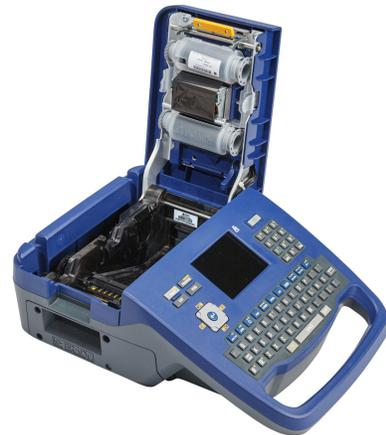
2. Retirez les étiquettes existantes, le cas échéant. Saisissez le rouleau d'étiquettes installé et retirez-le doucement du compartiment des étiquettes. Conservez les étiquettes inutilisées dans un endroit frais et sec.
