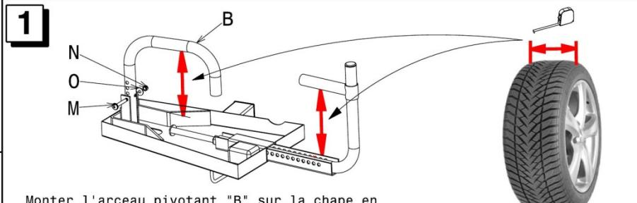
Monter l'arceau pivotant "B" sur la chape en choisissant le trou approprié à la largeur de la roue
