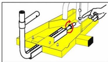
Retirer l'antivol, serrer le sabot en position, puis remettre les 2 bras en position verrouillée.
